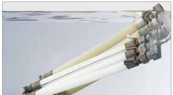
Рис. 3-4 Трубы в момент длительного испытания (под давлением в водном резервуаре)
