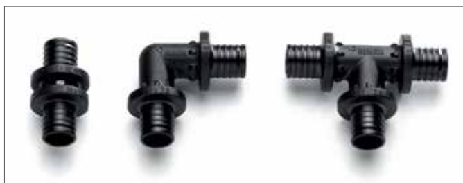
Рис. 6-2 Фитинги RAUTITAN PX из PPSU (полифенилсульфона)
